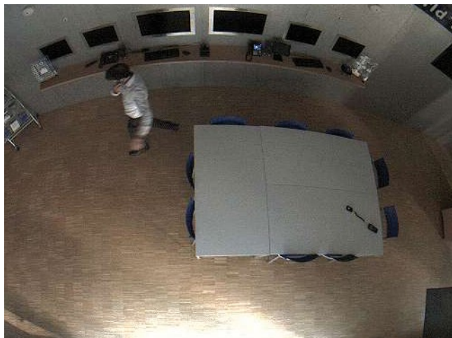
Помещение, интенсивность освещенности: 30 люкс, 3-мегапиксельный видеодатчик без MxLEO
